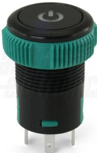
Pulsante - Pulsante - Monostabile - Luminoso: si - Luce: Rosso/Verde - 20Vdc - Nero - SPST - 20A@12Vdc - OFF/(ON) - N.A. - 3 terminali faston 4,8 - 18mm x ø19.2mm - Attuatore: Plastica - IP67
