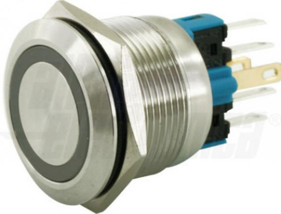
Pulsante - Antivandalo - Pulsante - Monostabile - Luminoso: si - Luce: Rosso - 24Vac/dc - Metallo - SPST - 5A@250Vac, 5A@36Vdc - N.C. + N.A. - 6 terminali a saldare - ø22mm - Attuatore: Acciaio - IP65
