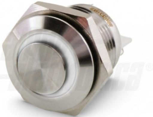
Pulsante - Antivandalo - Pulsante - Monostabile - Luminoso: si - Luce: Bianco - 12Vac/dc - Metallo - SPST - 3A@36Vac/dc, 3A@12Vac/dc - OFF/(ON) - N.A. - 3 terminali a vite - ø16mm - Attuatore: Acciaio - IP65
