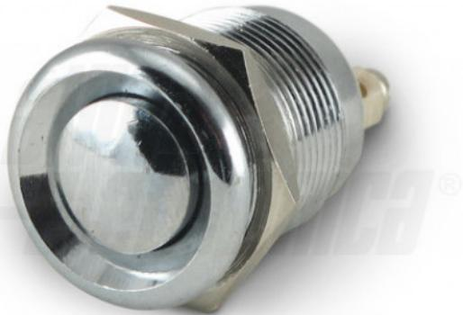
Pulsante - Antivandalo - Pulsante - Monostabile - Luminoso: no - Metallo - SPST - 2A@250Vac, 4A@125Vac - OFF/(ON) - N.A. - 2 terminali a vite - ø19mm - Attuatore: Ottone nichelato - IP66
