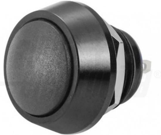
Pulsante - Pulsante - Monostabile - Luminoso: no - Nero - SPST - 2A@250Vac, 2A@36Vdc - OFF/(ON) - N.A. - 2 terminali a saldare - Ø12.5mm - Attuatore: Zn-Al - IP65
