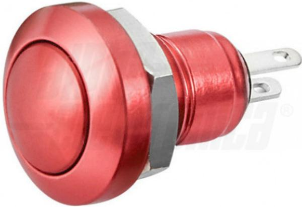
Pulsante - Pulsante - Monostabile - Luminoso: no - Rosso - SPST - 1A@24Vdc - OFF/(ON) - N.A. - 2 terminali a saldare - ø8mm - Attuatore: Zn-Al - IP65
