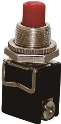
Pulsante - Pulsante - Monostabile - Luminoso: no - Rosso - SPST - 4A@250Vac, 8A@125Vac - OFF/(ON) - N.A. - 2 terminali a vite - ø12mm - Attuatore: Plastica - IP40
