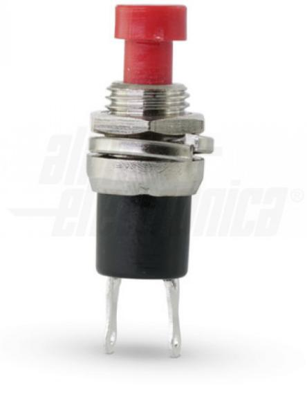
Pulsante - Pulsante - Monostabile - Luminoso: no - Rosso - SPST - 1A@250Vac, 3A@125Vac - OFF/(ON) - N.A. - 2 terminali a saldare - ø7mm - Attuatore: Plastica
