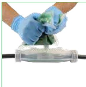
Agganciare l'ugello erogatore al corpo del guscio, ruotare di 45 gradi per rilasciare la resina e riempire il guscio
