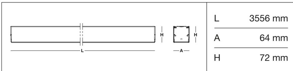
**Struttura portante cablata per canali continui, idonea per: unità luminose 3F Linux L o trasporto di linee elettriche.**
